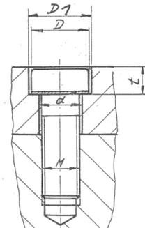
**Senkung vgl. DIN74 Form F für Schrauben mit Senkkopf**
