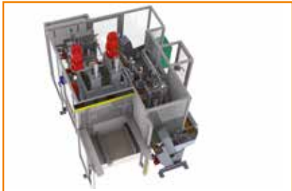
Halbautomatische Montagepresse für Gummilager mit Option der Vollautomatisierung Semiautomatic assembly press for rubber bushes with the option for complete automation
