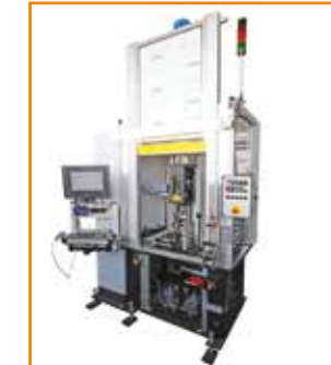
Prüfstand zur Vermessung des Axialspiels Test bench for the measurement of the axial play
