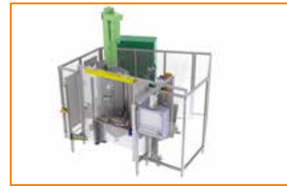
Halbautomatischer Montage-Rundschalttisch zum Verpressen und Prüfen von Axialgelenken Semiautomatic rotary indexing assembly table for the pressing and testing of axial joints
