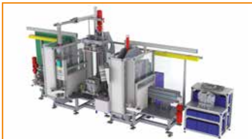
Halbautomatisches Montagemodul mit Handarbeitsplatz, Montagepresse und Prüfstation Semiautomatic assembly module with manual workplace, assembly press and test station
