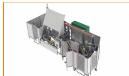
Halbautomatisches Montagesystem mit vollautomatischem Vormontage-Rundschalttisch und Handarbeitsplatz zur manuellen Eingabe von Fahrerhausschwingen inkl. Qualitätskontrolle, Datenarchivierung und Betriebsdatenauswertung. Semiautomatic assembly system with fully automatic pre-assembly rotary indexing table and manual workplace for the manual input of driver's cabin vibrations incl. quality control, data archival and operational data evaluation
