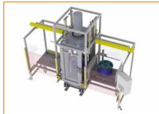
Halbautomatische Montagepresse zum Prägen von Alufelgen Semiautomatic assembly press for stamping aluminium wheels
