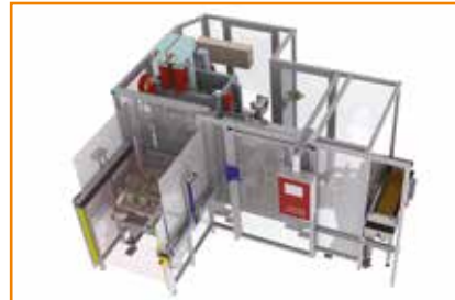
Halbautomatische Montagepresse für Gummilager Semiautomatic assembly press for rubber bushes
