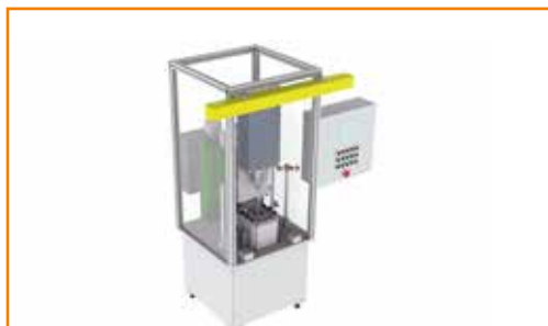
Halbautomatische Montagepresse für Boilergehäuse Semiautomatic assembly press for boiler housing
