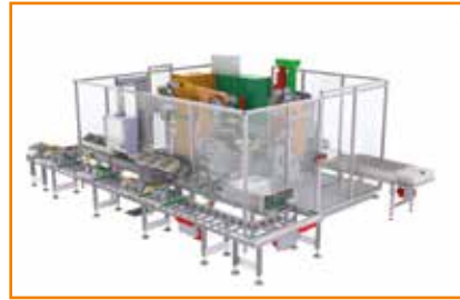
Halbautomatisches Montagesystem mit Werkstückträger-Eingabepuffer und über Roboter verkettete Montagepressen Semiautomatic assembly system with workpiece carrier input buffer and assembly presses linked via robots
