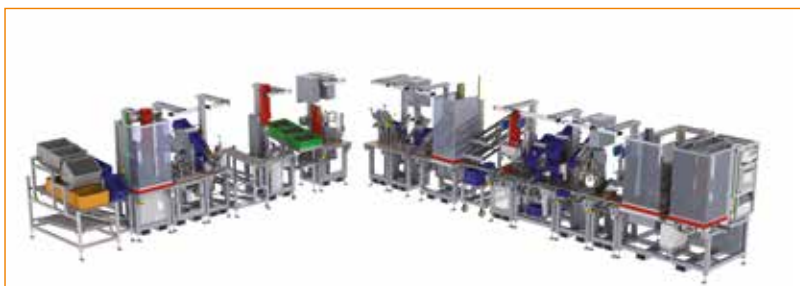
Halbautomatische Montagepresse für Boilergehäuse Semiautomatic assembly press for boiler housing
