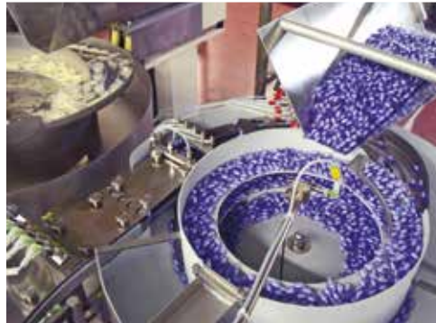
Diverse Beispiele für Anwendungsfälle im Bereich Zu- führung und Sortierung von Einzelteilen für Zuführung aus dem Schüttgut Various examples of applications in the area of supply and sorting of individual components for the supply from bulk cargo
